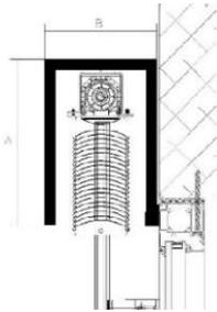
Standardausführung: U-förmiger Kasten aus Purenit-material, einschließlich Seitenwänden mit einer in der Mitte gefrästen Nut zur Aufnahme eines verdeckten Gehäuses oder einer vorgefertigten Verkleidung. Der Kasten ist nicht isoliert. Im Preis inbegriffen sind ineinander greifende Profile in den Breiten 20, 25, 30, 35, 40 (siehe Erläuterungen). Die Kästen sind geklebt und geklammert. Die längste mögliche Länge in einem Stück beträgt 3500 mm (oder entsprechend den Transportmöglichkeiten).
