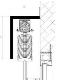
Standardausführung: L-förmiger Kasten aus Purenit-material, einschließlich Seitenwänden mit einer in der Mitte gefrästen Nut zur Aufnahme eines verdeckten Gehäuses oder einer vorgefertigten Verkleidung. Der Kasten ist nicht gedämmt. Im Preis inbegriffen sind ineinander greifende Profile in den Breiten 20, 25, 30, 35, 40 (siehe Erläuterungen). Die Kästen sind geklebt und geklammert. Die längste mögliche Länge in einem Stück beträgt 3500 mm (oder entsprechend den Transportmöglichkeiten).
